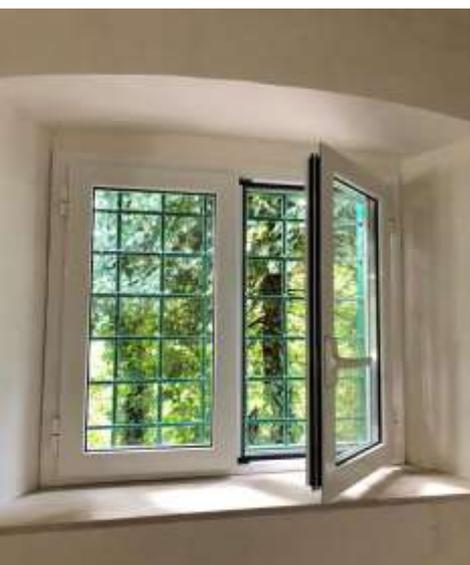
Profilati alluminio a taglio termico per la produzione su misura di *finestre e porte-finestre* a una o più ante con possibilità opzionale di apertura a *ribalta* o a *vasistas*. Il ponte termico tra facciata esterna ed interna è ottenuto con l'inserimento di listelli in poliammide alveolare, rinforzato con fibra di vetro, in grado di assicurare un ottimo isolamento termico/acustico e un elevato risparmio energetico.
